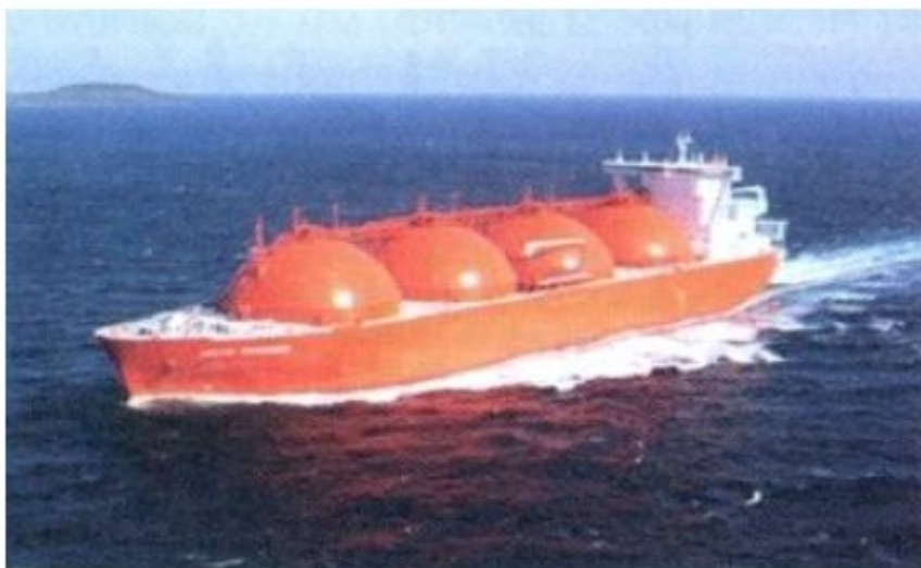
2.6-rasm. Sferik turdagi rezervuarli suyultirilgan gazlarni tashiydigan tankerlarning tashqi ko‘rinishi
