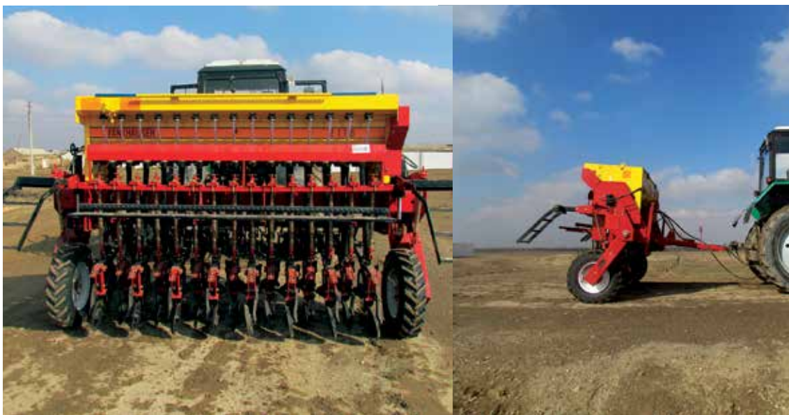
22-расм. Дала экинларини шудгор қилинмаган тупроққа экиш учун мўлжалланган сеяланинг орқа ва ўнг томондан кўриниши
