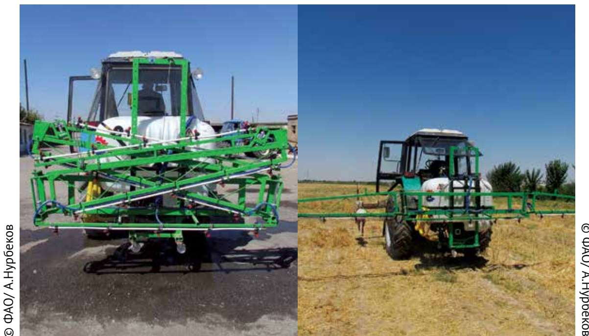
23-расм: Штангали пуркагичнинг ҳаракатланиш ва далада ишлаш жараёнидаги ҳолати
