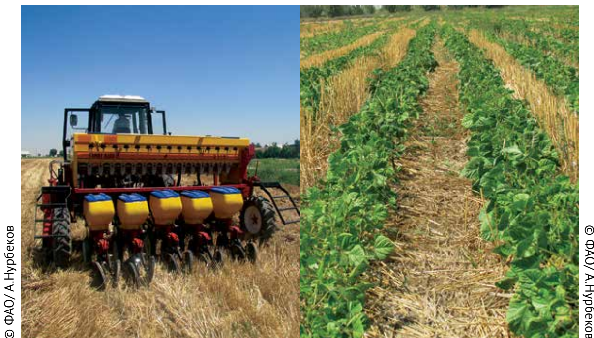
20-расм: Мошнинг шудгор қилинмаган ерга экиш имкониятига эга сеялка ёрдамида экилиши (чапда) ва шудгор қилинмаган ерга экилган мош даласининг кўриниши (ўнгда)
