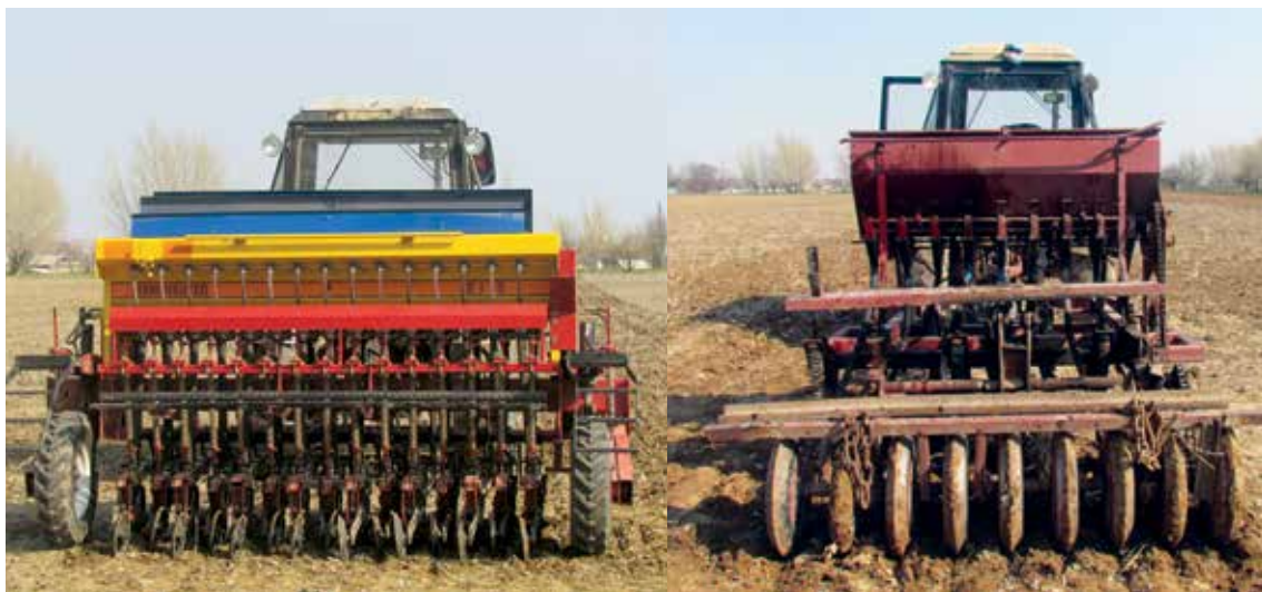
10-расм: Маҳаллий СЗС-2.1 анғизга экиш сеялкаси (чапда) ва шудгор қилинмаган ерга экишга мўлжалланган FANKHAUSER 2115 сеялкаси (ўнгда)
