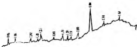
129 – rasm. Yoqilg'i kul-shlakining rentgenogrammasi
