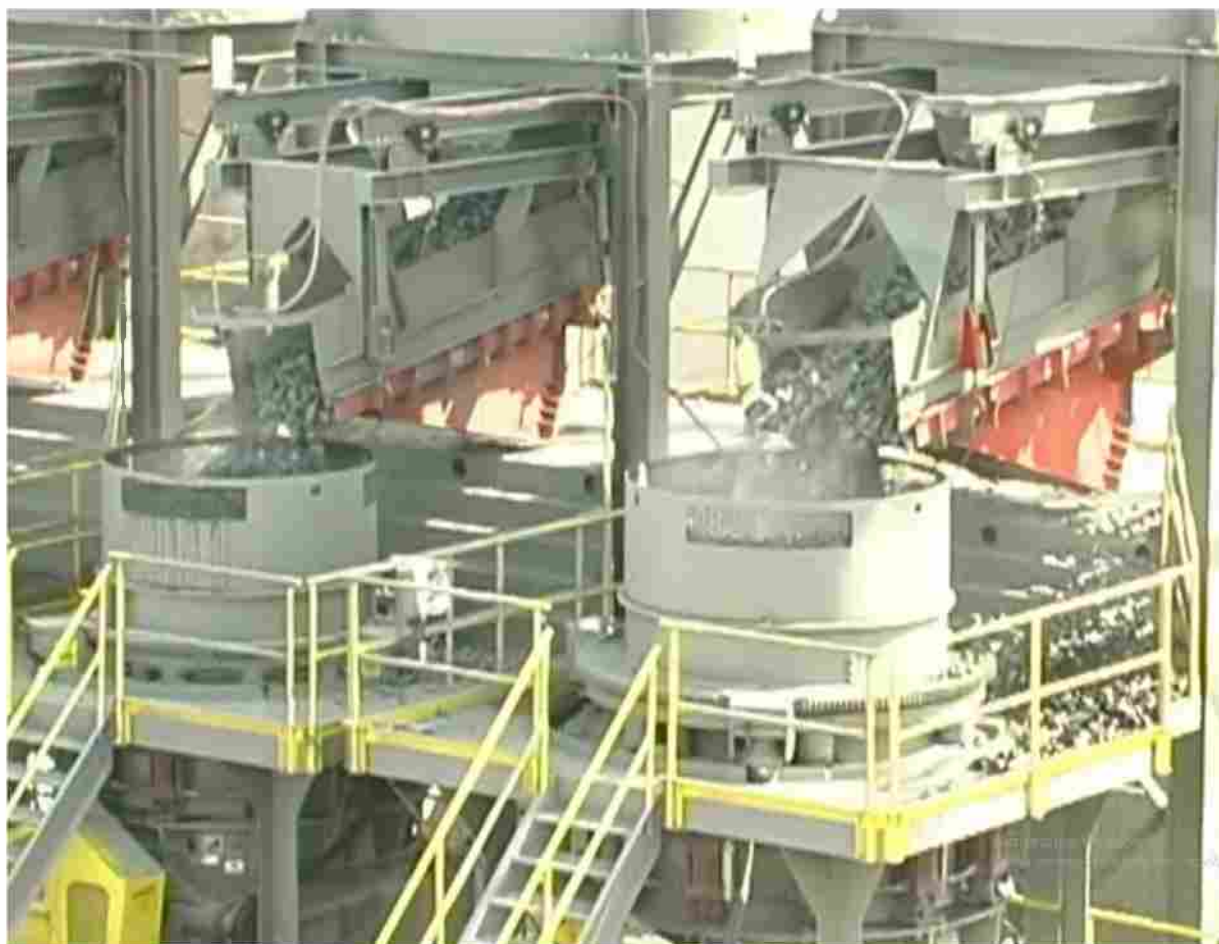
41-rasm. O'rta va mayin maydalovchi konusli maydalagichlarning o'rnatilishi
