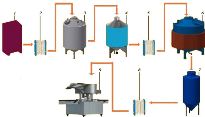
Рисунок № 5.1. Инновационная технологическая схема рафинирования, дезодорирования хлопкового масла, полученного методом прессования
