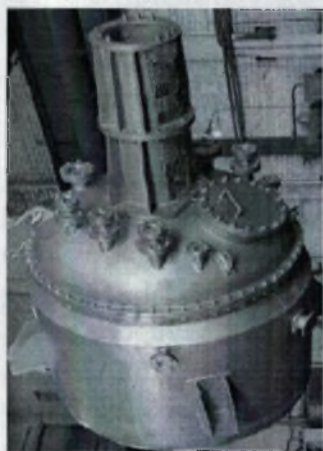
3.16 - rasm. G'ilof payvandlangan ideal aralashtirish sig'imli reaktorning umumiy -(a) va uning (b)- sxematik ko'rinishlari.
