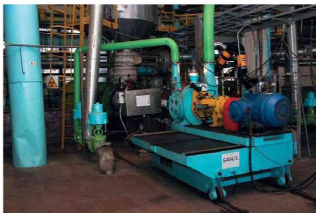
11.21 -rasm. Yuqorida – polietilenni granullash apparati. Shnek elektr pechining issiqlik izolyatsiya o‘rami yaxshi ko‘ringan elektropechi shneka
