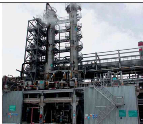
11.15 - rasm. Chapdan tovar BDFni olish kolonnasi, o‘ngdan – kolonna – ikkilamchi depropanizator BDF va maqsadli mahsulotlarni maksimal chiqishi va tozaligini ta’minlash: etilenni, propilenni, C 4 fraksiyasini, C 5 fraksiyasini va pirokondensatni.
