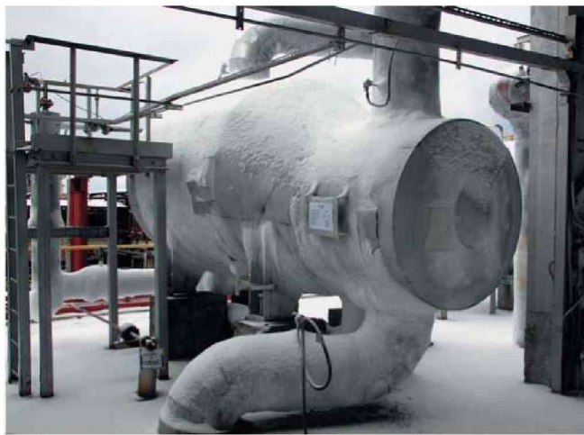
11.11-rasm. Metanni va vodorodni ajratish blokining issiqalmashinish apparatlaridan biri. Bu yerda sovituvchi agent sifatida suyuq etilen kirishadi, pirogaz esa - 55 °C gacha sovitiladi
