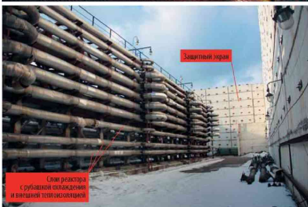
11.19 -rasm. Etilenni yuqori bosimda polimerlash reaktori. Himoya ekrani yaxshi ko'ringan.
