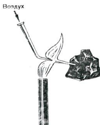
Rasm 89- Metall oksidlarini ko'mir bo'lakchasida qaytarish.
