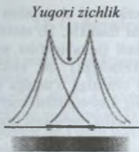
2.5-rasm. Elektron zichligining yadrolar orasida ortishi bir xil amplitudali qo'shni orbitallar interferensiyasi natijasida yuzaga keladi.
