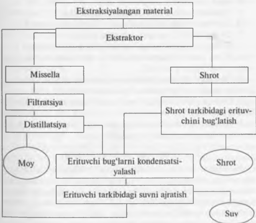
70-rasm. Presslash usulida moy olingan xomashyoni kunjarasidan ekstraksiya usulida moy olish jarayoni texnologiyasining strukturaviy sxemasi (umumlashtirilgan holda).
