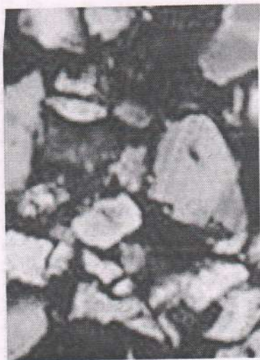
3.5.10-Rasm. Ugun koni kvarts qumining (x40) kattalikda olingan skanerli elektron mikroskopik tasviri
