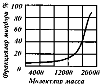
20-расм. Полиамиднинг молекуляр массаси бўйича тақсимланиш графиги.
