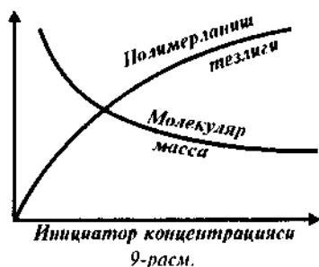
Инициатор концентрациясининг полимерланиш тезлигига ва полимернинг молекуляр массасига таъсири.
