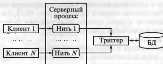
Рис. 10.8. Многопоточковая односерверная архитектура
