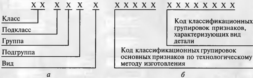
Рис. 18.15. Структура конструктивно-технологического кода детали:
