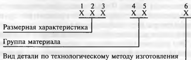
Рис. 18.14. Признаки технологической классификации деталей
