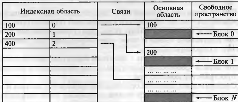
Рис. 3.4. Структура записей данных в файлах с неплотным индексом
