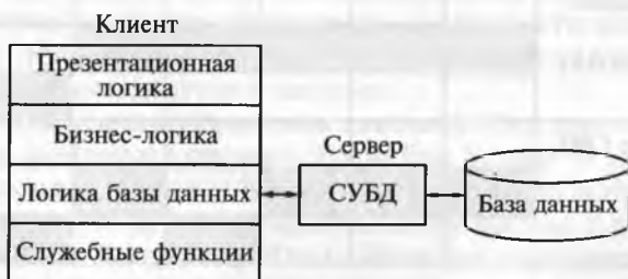
Рис. 10.2. Структура типового приложения, работающего с базой данных
