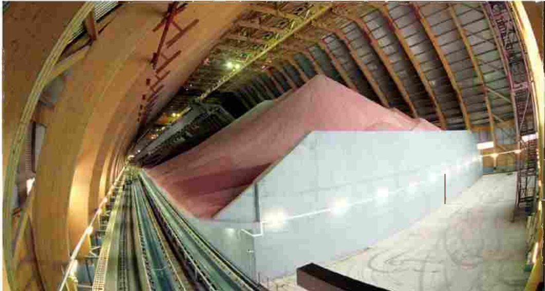
39-rasm. Verxnakamsk konida qazib olinayotgan rudani yer ostida me'yorlashtirish uchun barpo qilingan bunker.
