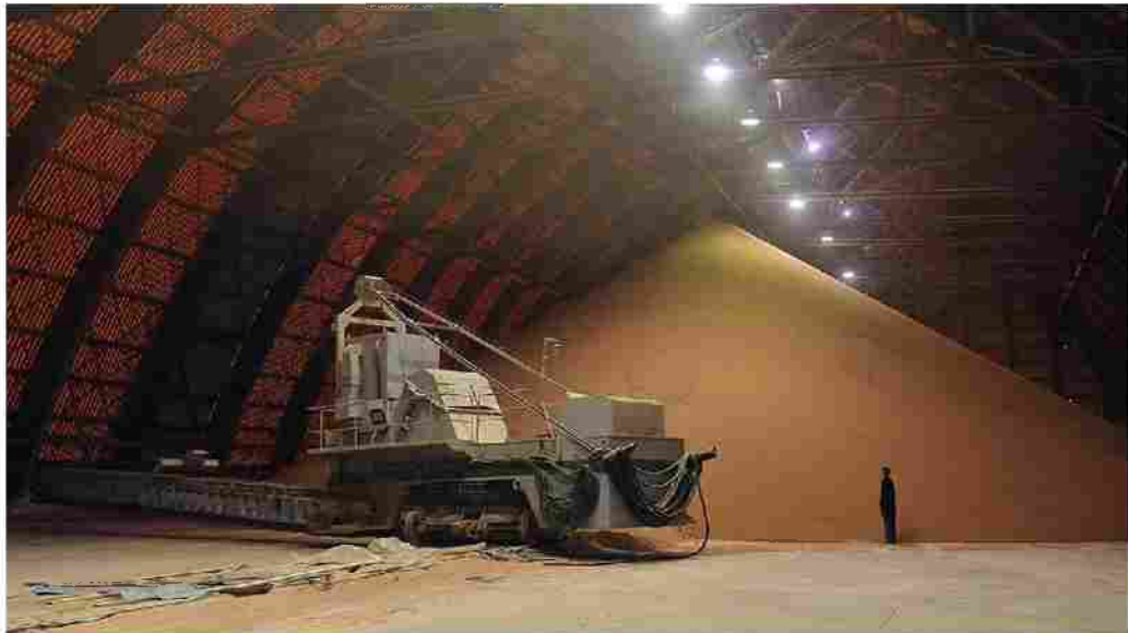
38-rasm. Uralkaliyda qazib olinayotgan rudani yer ostida me'yorlashtirish uchun barpo qilingan bunker.
