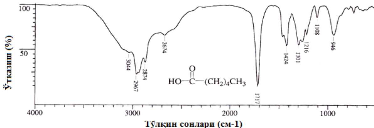
28-расм. Гексан кислотасининг ИҚ-спектри
