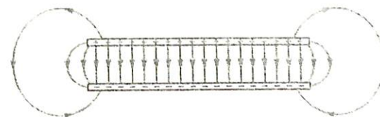
2.7-chizma. Yassi kondensatoridagi elektr maydon 36
