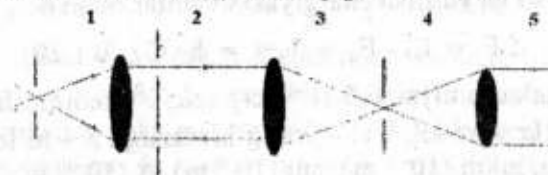
1.2-rasm. Refraktometrning sxemasi: 1 — kollimator; 2 — nur o'tkazuvchi ikki tirqish; 3 — ob'ektiv; 4 — fokus tekisligi; 5 — okulyar.
