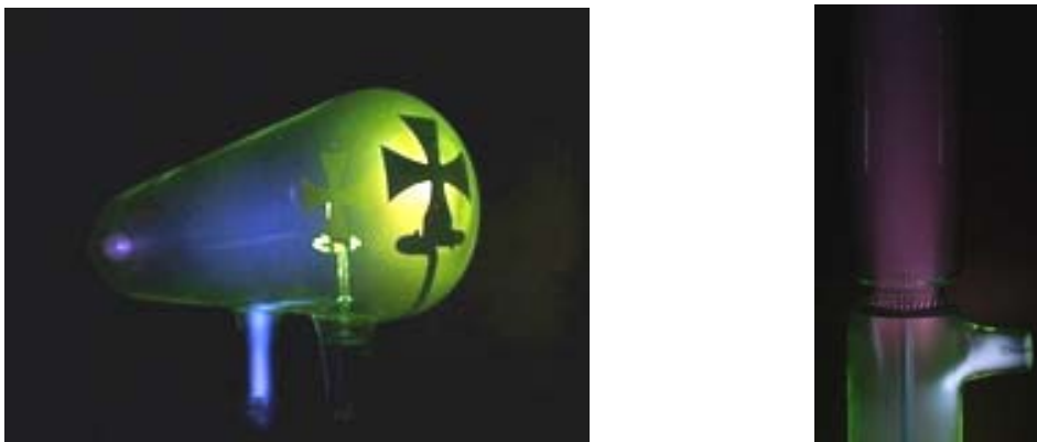
Рисунок 20. «Трубка Крукса» (слева) и каналовые лучи (справа)
