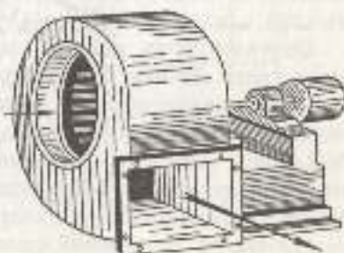
2-расм. Марказдан қочма кучга асосланган вентилятор
