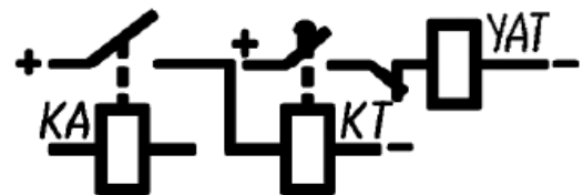
4.9-rasm. Vaqt relesini ulash sxemasi.
