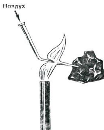
Rasm 89- Metall oksidlarini ko'mir bo'lakchasida qaytarish.
