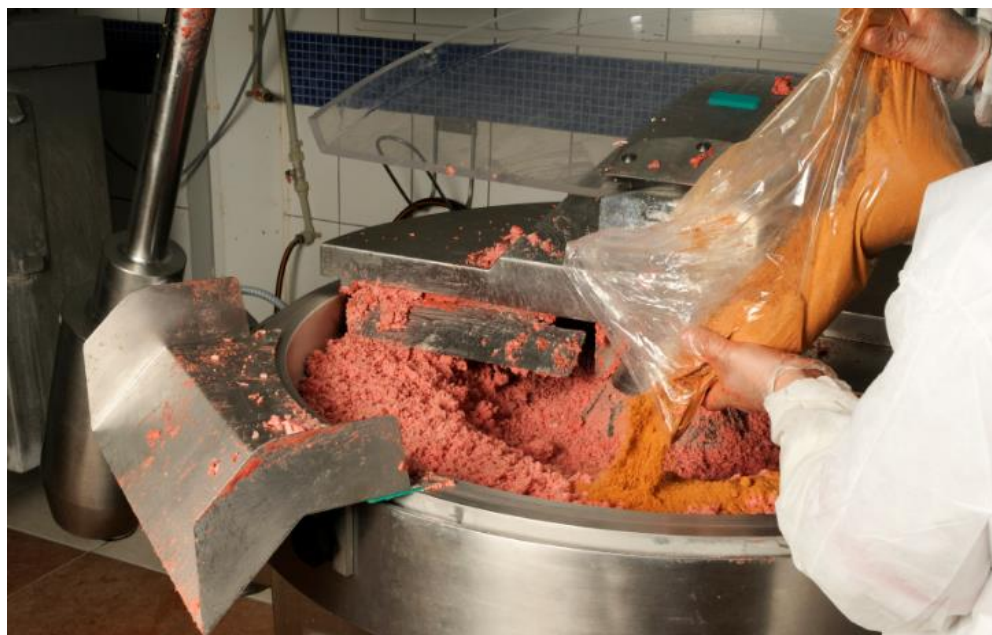
4-rasm. Go'sht qiymasiga kutter jihozida stabilizator qo'shish jarayoni
