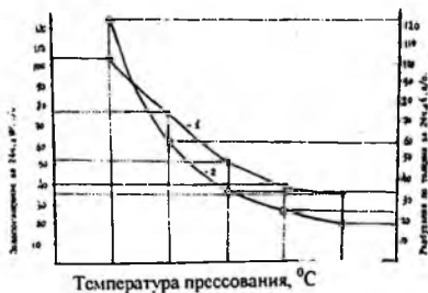
Рис. 3. График зависимости разбухания и водопоглощения от температуры прессования 1- \Delta W , 2- \Delta h
