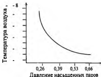
Рис. 1. Зависимость температуры смеси, при которой возможен пуск двигателя, от давления насыщенных паров топлива.
