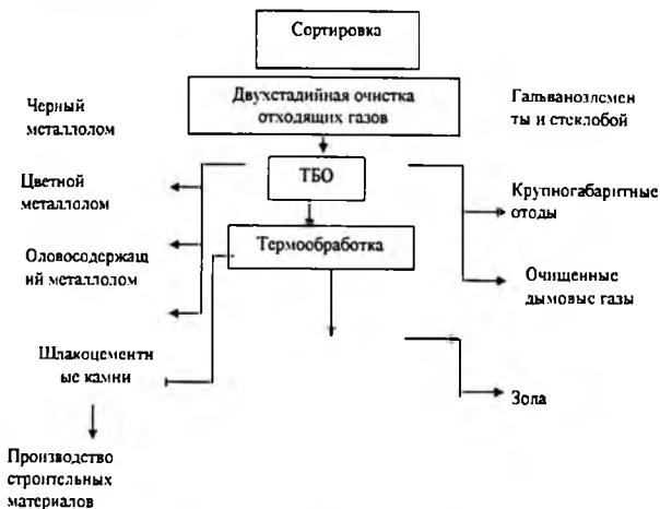
Рис.1. Схема технологий комплексной переработки твердых бытовых отходов.
