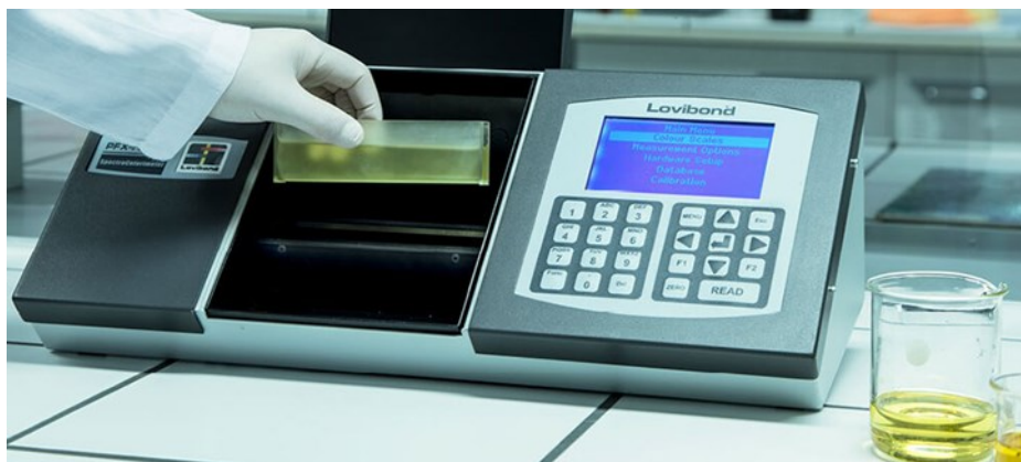
5-rasm. Lovibond laboriy jihozida paxta moyining rang ko‘rsatgichini aniqlash jarayoni
