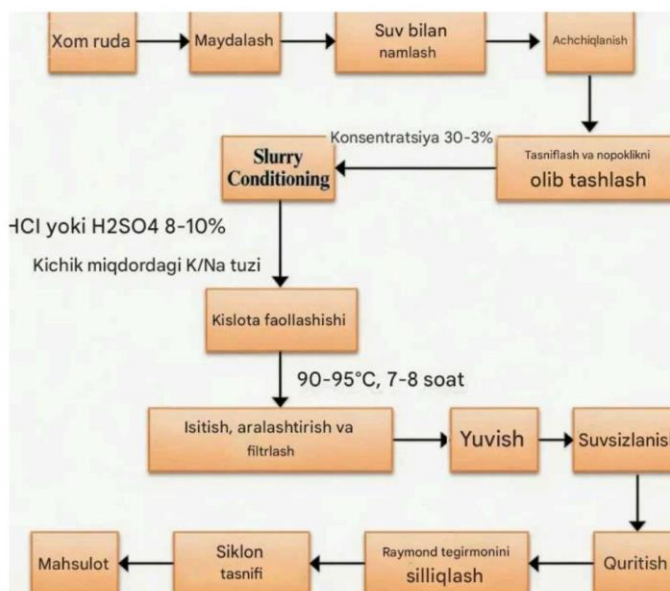
11-rasm. Bentonitni qayta ishlashning texnologik sxemasi
