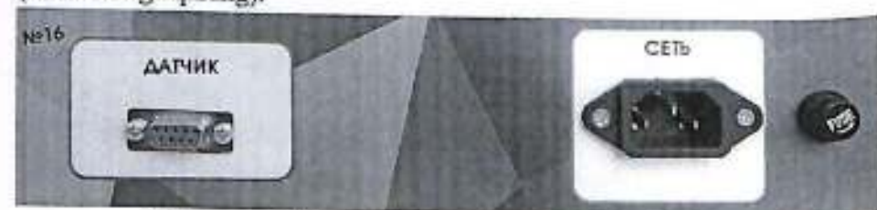
25.5-rasm. Elektron sekundomerning orqa paneli.
