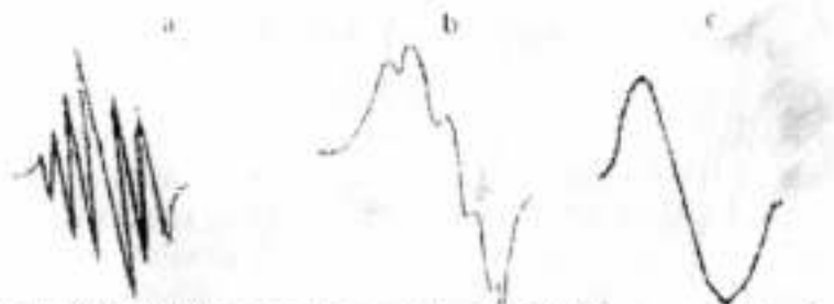
7.17-rasm. Sakkizta vodorod yadrosi protonlaridan O'NS konstantalarining har xil kenglikdagi liniyalari: H=0,5 Gs – (a); H=5 Gs – (b); H=20 Gs – (c).
