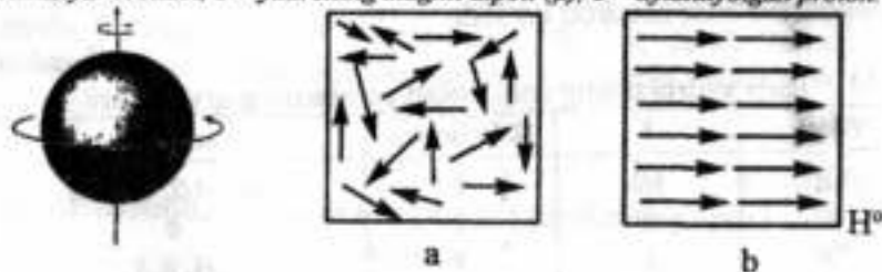
6.2-rasm. Yadro spini. Tashqi magnit maydoni ( H_0 ) bo'lmaganda - (a) va H_0 mavjudligida - (b) yadro dipolining yo'nalishi.
