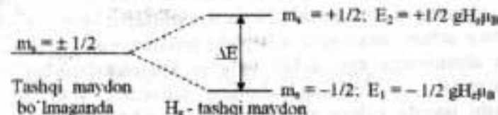
5.5-rasm. Tashqi magnet maydoni ( H_x ) ta'sirida elektron spini energetik darajalarining ajralishi.
