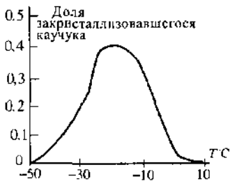
Рис. 4.3. Зависимость скорости кристаллизации натурального каучука от температуры
