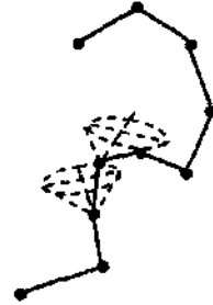
Рис. 2.7. Конформация цепи с фиксированными валентными углами.
