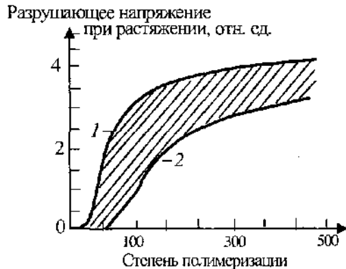
Рис. 7.1. Зависимость разрушающего напряжения при растяжении от степени полимеризации для полимеров с наибольшей (1) и наименьшей (2) прочностью.
