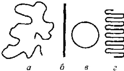
Рис. 2.8. Конформации макромолекул: a – макромолекулярный клубок; б – вытянутая жесткая палочка; в – глобула; г – складчатая конформация.
