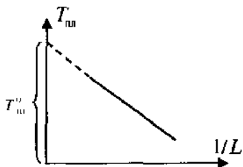
Рис. 4.7. Зависимость наблюдаемой температуры плавления T_{пл} от размера складки монокристалла полимера.
