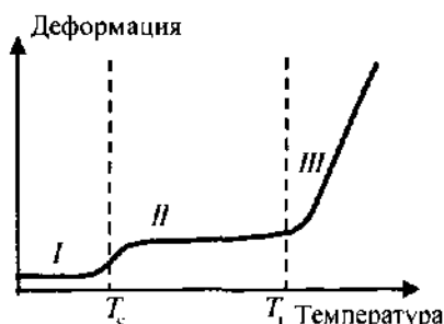
Рис. 6.9. Термомеханическая кривая аморфного линейного полимера.
