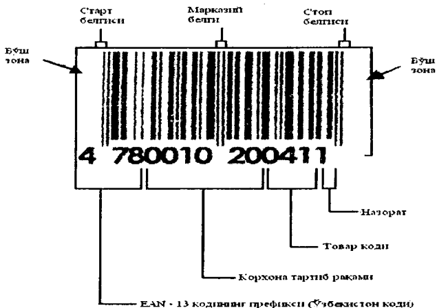
2.2-расм. EAN-13 коднинг структураси.
