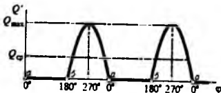
2.2.3-rasm. Uch (porshenli) harakatli nasosning uzatish grafigi
