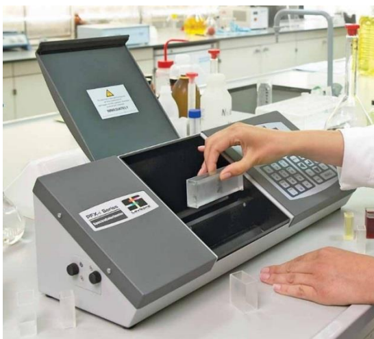
Rasm 6. Lovibond jixozida glitserin rangini aniqlash jarayoni
