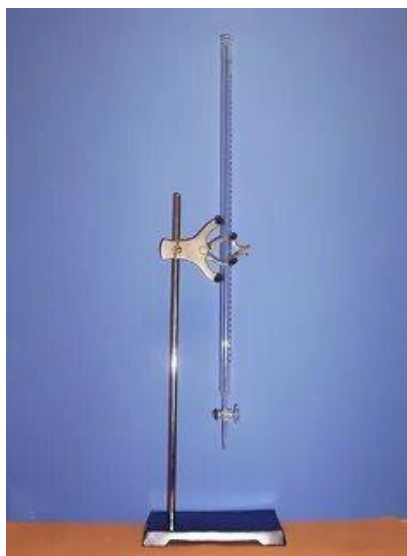
Rasm 4. Shtativga o'rnatilgan byuretka
