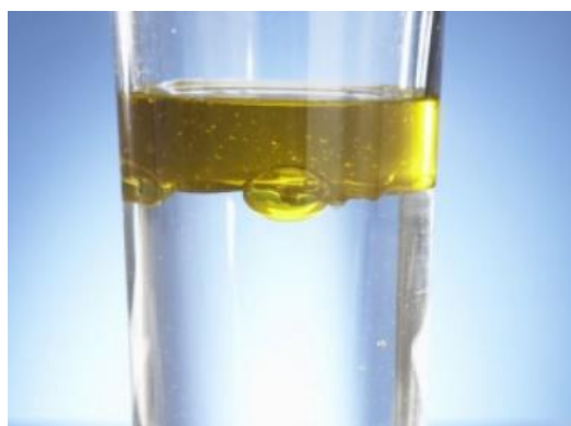
Rasm 3. Emulgator qo'shilmagan «suv moy» emulsiyasi
