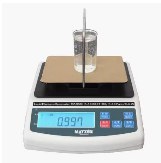
Rasm 5. MZ-G300 rusumli elektro'n areometr
