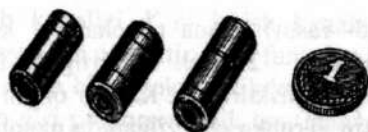
4.6-rasm. Endoradiozondning tashqi ko'rinishi. O'ng tomonda bir tiyinlik tanga bilan kattaligi solishtirilgan.
