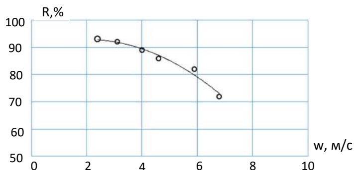
Рис.1. Влияние скорости газовой фазы на степень очистки дымовых газов от SO_2 .
