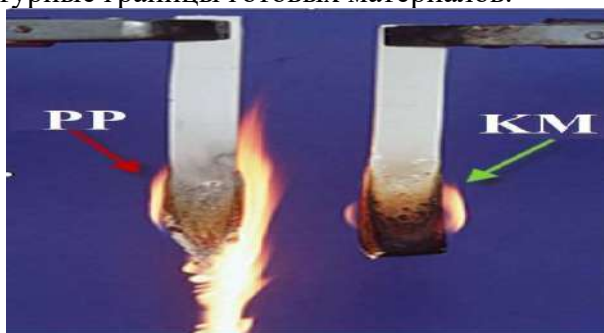
Рис. 1. Улучшение стойкости к возгоранию в компаундах ПП+30%волокна
