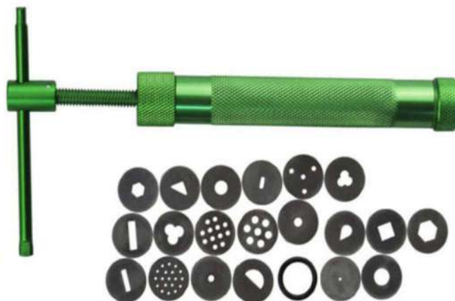
Расм. Цилиндрсимон гранула тайёрлаш учун совуқ экструзия мосламаси
