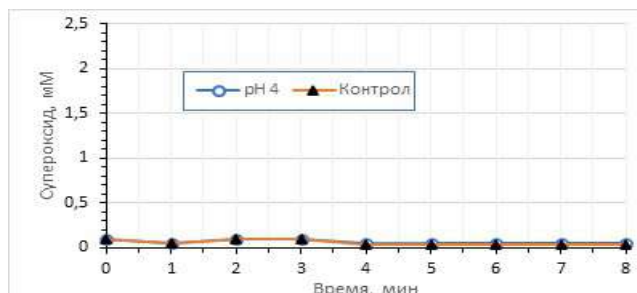
Рис.3. Влияние pH на образование супероксида в 0,25 моль/л водном растворе перкарбоната натрия при pH 4.
