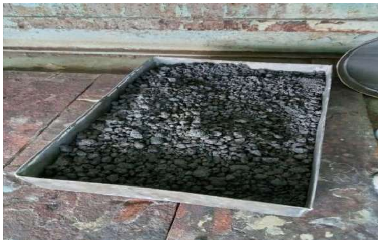
1-расм. Конвертер чанги кислотали оқова суви билан ишлов берилгандан кейинги хосил бўлган кек
