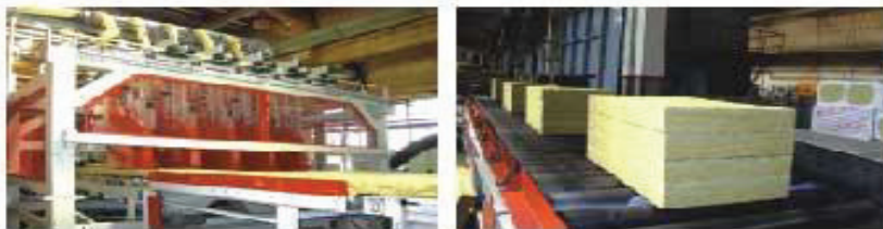
28- rasm. Mahsulotni zamonaviy kesish uzeli.
