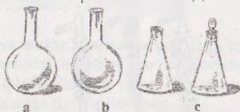
2-rasm. Kolbalar: a - tagi yassi; b - tagi dumaloq; c - konussimon
