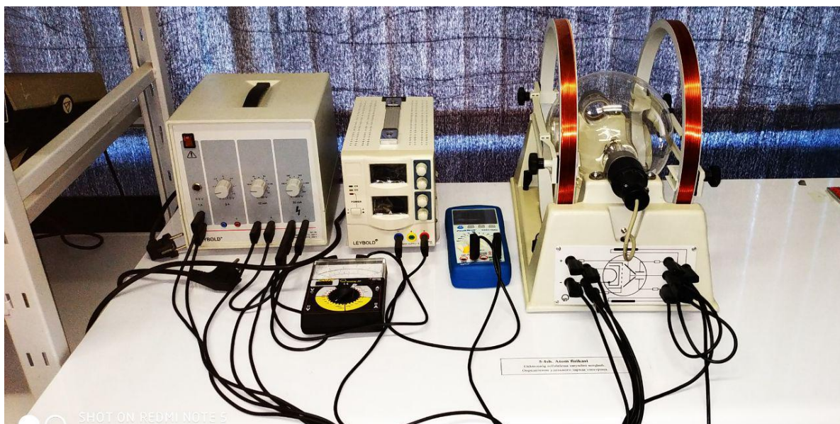
3-rasm. Elektronning solishtirma zaryadini aniqlash qurilmasining umumiy ko'rinishi.
