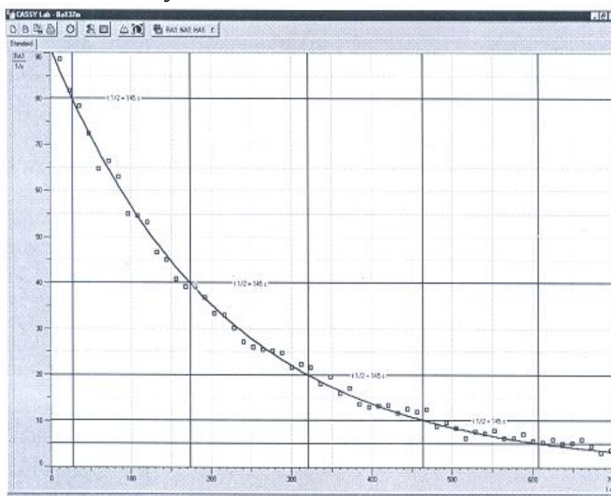
5-rasm. Ba – 137 m ning CASYS bilan o'lchangan va boholangan yemirilish grafigi.
