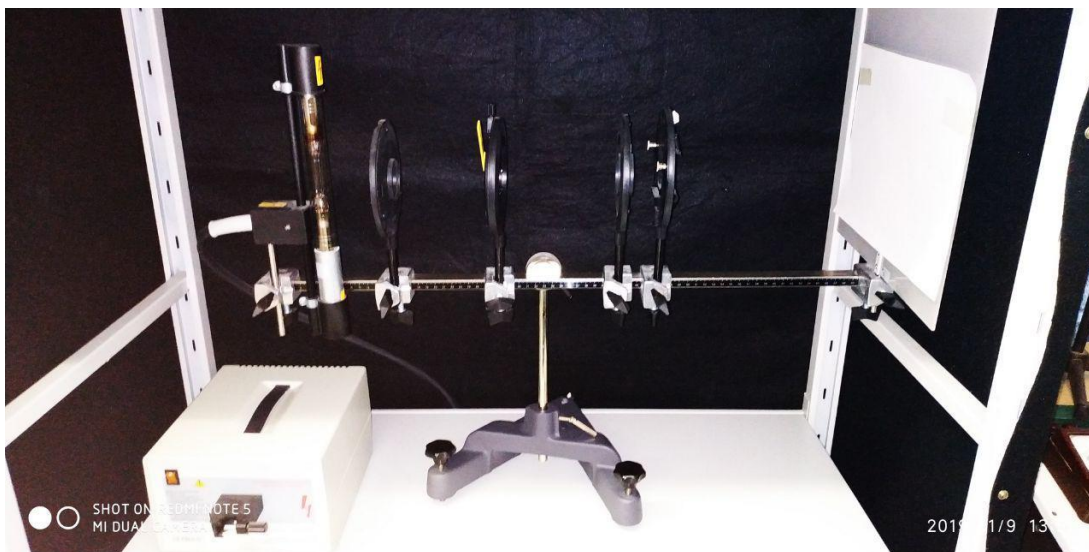
2-rasm. Atomar vodorodning Balmer seriyalarini o'rganish uchun eksperimental qurilma (rasmda optik stol ustida Leybold ko'p tutgichining chap qismi vaziyati ko'rsatilgan).
