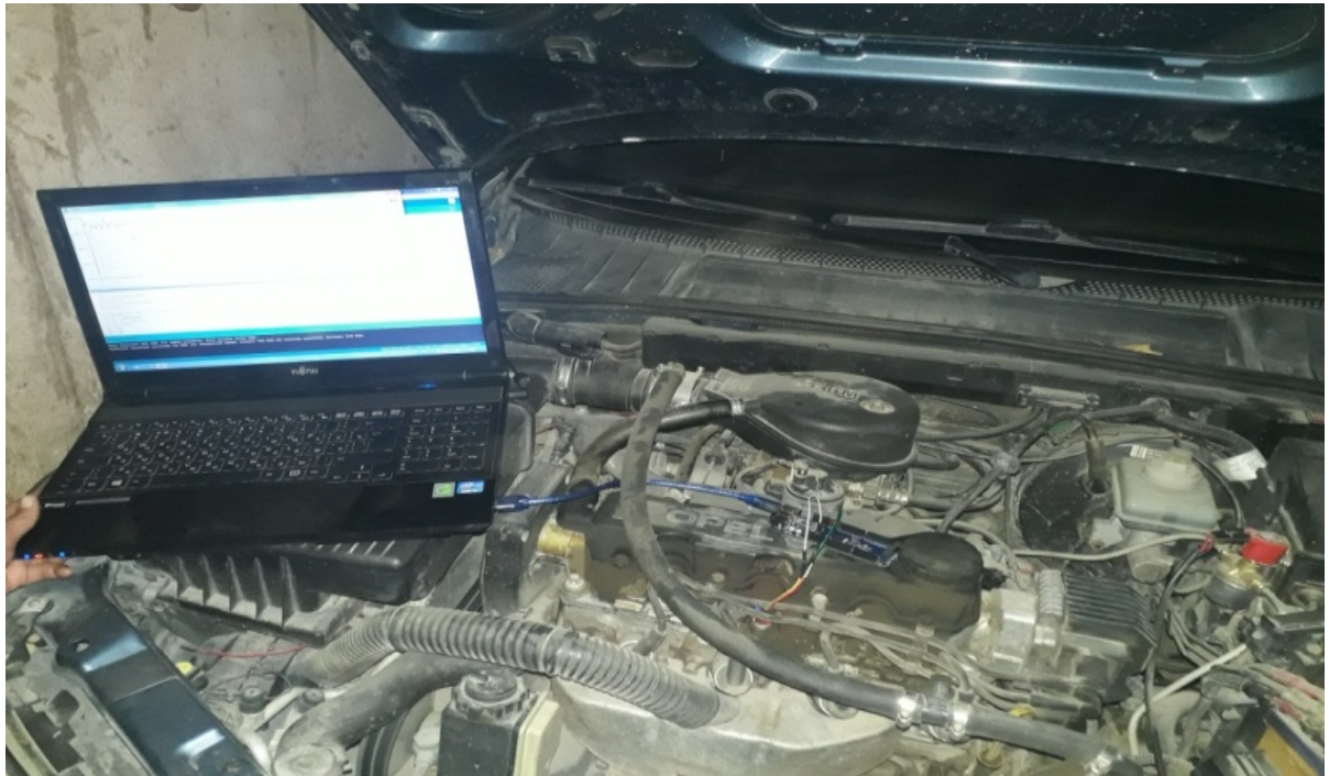
Рисунок 4.1. - Экспериментальная система измерения виброакустических сигналов ДВС автомобиля марки Opel Vectra
