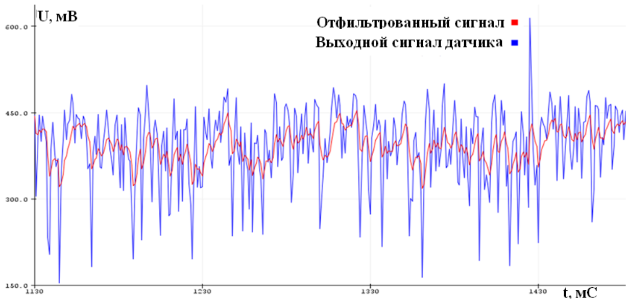
Рисунок 2.5. - Графики зашумленных и отфильтрованных виброакустических сигналов ДВС автомобиля марки Opel Vectra
