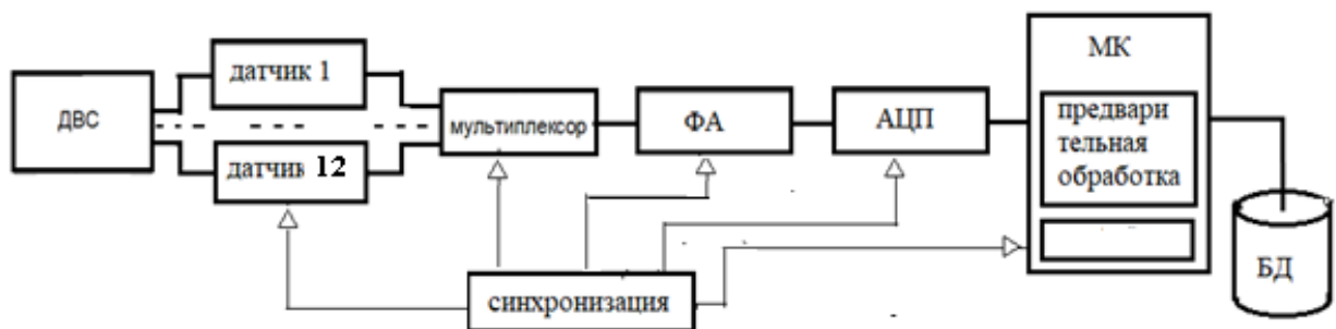
Рисунок 4.2. - Структура аппаратных средств АИК диагностирования ДВС
