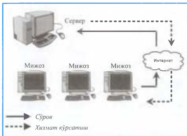
3.3 - расм. Мижоз/сервер тизимининг ишлаш принципи
