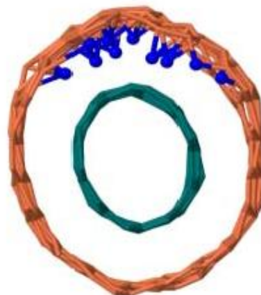
3.3-rasm. IQUNT (5.5 va 10.10) dagi azot atomlarining inkapsulyatsiya jarayoni: a- yon tomondan, b - ko'ndalang kesimi tomondan ko'rinishi.
