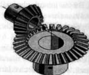
O'qlari o'zaro kesishgan konus tishli uzatma (g'ildiraklar to'g'ri tishli)
