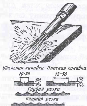
Рис. 9.33. Схема поверхностной кислородной резки и формы выплавляемых канавок
