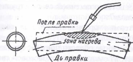
Рис. 1.10. Схема газопламенной правки металла.
