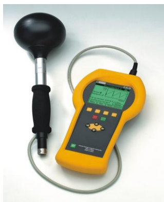
2.3-rasm. Elektr va magnit maydon kuchlanganligini o‘lchovchi kichik chastotali asbob (C.A 42)
