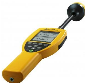
2.2-rasm. Elektr va magnit maydon kuchlanganligini o‘lchovchi asbob (Narda NBM-550)
