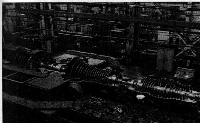
Конструкция турбины Т-250/300-240 (Т-теплофикационная; мощность 250/300МВт; давление пара на входе 240 атм (кг/см 2 ))
