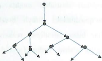
3-rasm. Tarmoqlangan zanjir reaksiya.
