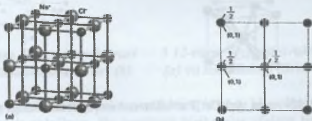
3.8-rasm. (a) Osh tuzining strukturasini va (b) tekislikdagi tasviri
