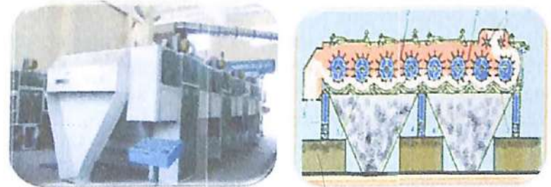
1- ta'minlovchi valiklar; 2- qoziqchali baraban; 3-to'rli sirt; 4- Ifloslik bunkeri; 5-lotok (nov).
