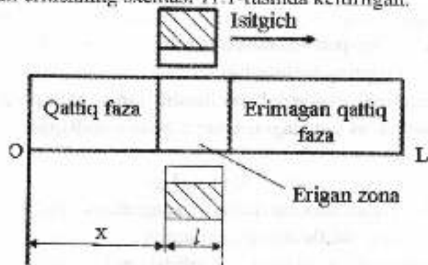
11.1-rasm. Zonali eritishning sxemasi.
