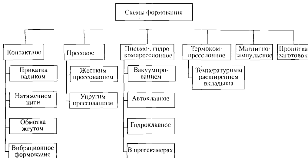
Рис. 9.72. Классификация схем формования
