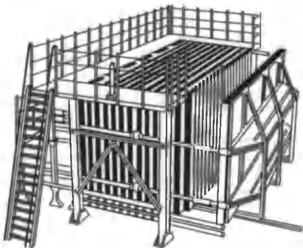
14.7-расм. Темир-бетон панеллар тайёрланадиган универсал кассета.
