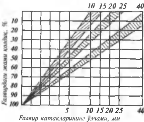
12.13-расм. Енгил бетонлар учун майда-йириклиги энг қулай бўлган тўлдиргичлар. Доналарнинг энг йириги:
