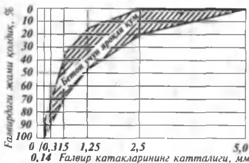
12.2-расм. Кумнинг майда-йириклигини ифодаловчи график.
