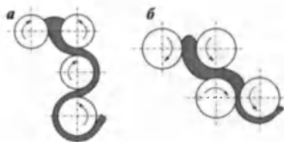
18.3-расм. Тўрт жўвали каландрнинг ишлаш схемаси:
