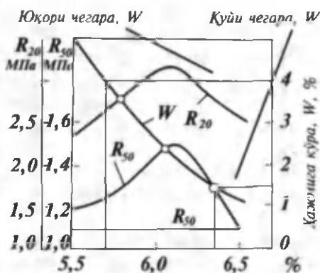
17.9-расм. Асфальт-бетон қоришмаси учун битум миқдорини аниқлаш.
