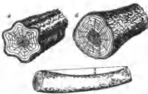
4.16-расм. Дарахт танасидаги нуқсонлар:
