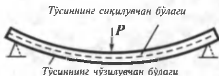
2.11-расм. Икки таянчдаги тўсиннинг эгилиши.
