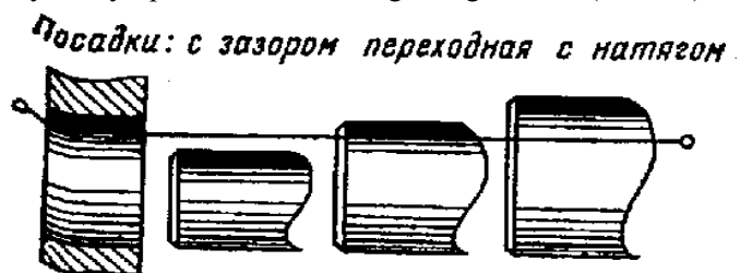
1- rasm. teshik tizimi sxemasi.
