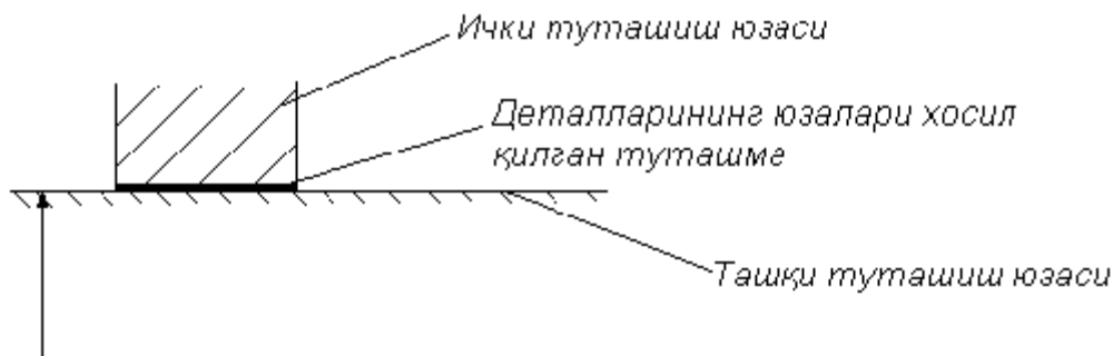
6.1-rasm. Tutashmaning xosil bo'lish sxemasi.
